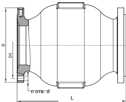
Габаритные и присоединительные размеры клапана PN 6,3 МПа
