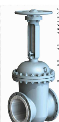
**Назначение** — применяются в качестве запорных устройств на трубопроводах для перекрытия потока рабочей среды. **Рабочая среда** — вода, пар, нефть, жидкие и газообразные нефтепродукты, природный газ, растворы пенообразо-вателей и другие, жидкие и газообразные среды, нейтральные к материалам деталей, соприкасающихся со средой. **Направление движения рабочей среды** — двухстороннее.
