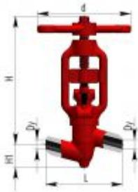
Данные вентили относятся к трубопроводной арматуре двухпозиционного эффекта, то есть они могут быть употреблены только открытия или перекрытия водопроводов. клапаны служат для полного перекрытия (открытия) напора воды методом возвратно-поступательного смещения закрывающего устройства. Присоединение к системе клапана 589-10-0 под сварку. Монтируемое положение на паропроводе разное, в верхней полусфере относительно паропроводов.
