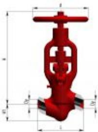
Запорный клапан - арматурный элемент, выполненный в форме запирающего клапана, который работает параллельно потоку рабочей среды. Проходное сечение любого вида клапана принято перекрывать запорной арматурой. Одним видом такой арматуры есть запорный клапан 1057-65-0, перекрывающий поток рабочей среды. При эксплуатации запорного вентиля, золотник – главный запирающий элемент, должен находиться в положении вкл или «выкл.».
